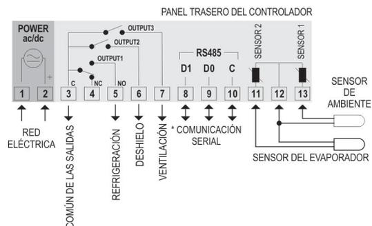
Fig. 01 – Conexiones mostradas en la etiqueta del controlador
