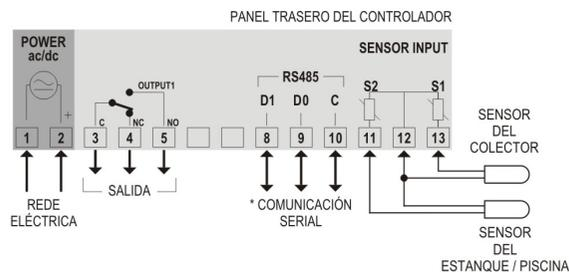
Figura 1 – Conexiones mostradas en la etiqueta del controlador
