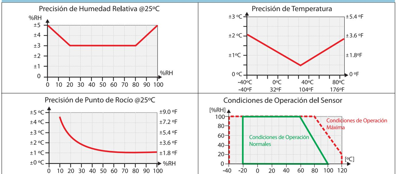
El sensor utilizado en este equipamiento puede ser dañado o descalibrado al ser expuesto a atmósferas contaminadas con agentes químicos. Ácido Clorhídrico, Ácido Nítrico, Ácido Sulfúrico y Amoníaco en concentraciones elevadas pueden dañar el sensor. Acetona, Etanol y Propilén Glicol pueden causar errores de medida reversibles.
