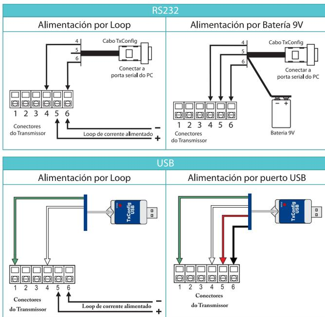
Conexiones de la Interface TxConfig
